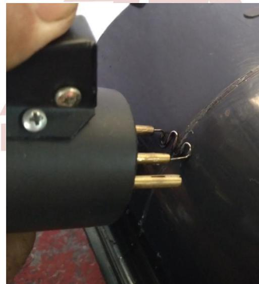
5 – Apoie o punho de acionamento com o grampo no local a ser reparado e acione o gatilho, pelo tempo necessário até a fusão no plástico.
